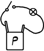
Le circuit est **alternativement ouvert** ou **fermé** selon la position de l'interrupteur.
